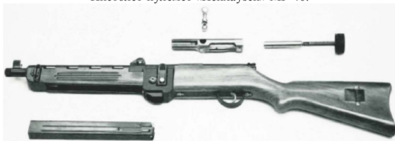
Разобранный пистолет-пулемёт «Нейхаузен» MP-46.
